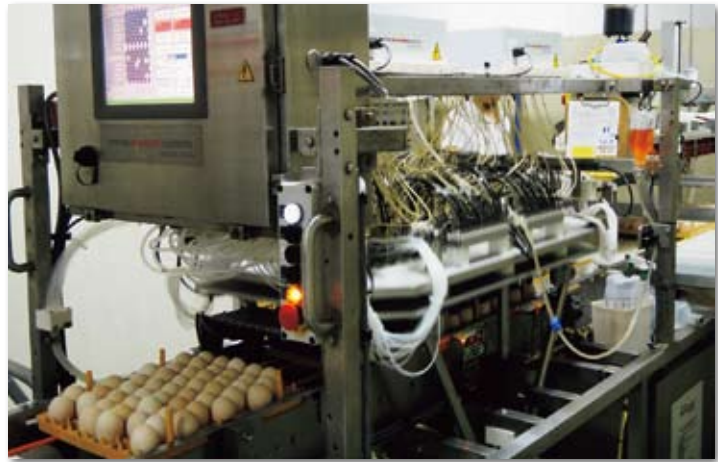
▲平成13年に導入したアメリカ製ワクチン接種機。卵内で发育中の胚に予防接種することにより、雛に早期の免疫獲得を促す最新技術
