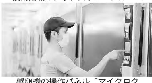
孵卵機の操作パネル「マイクロクライマー・コントローラー」。セクションごとの温湿度や二酸化炭素濃度などを精密に管理できる
